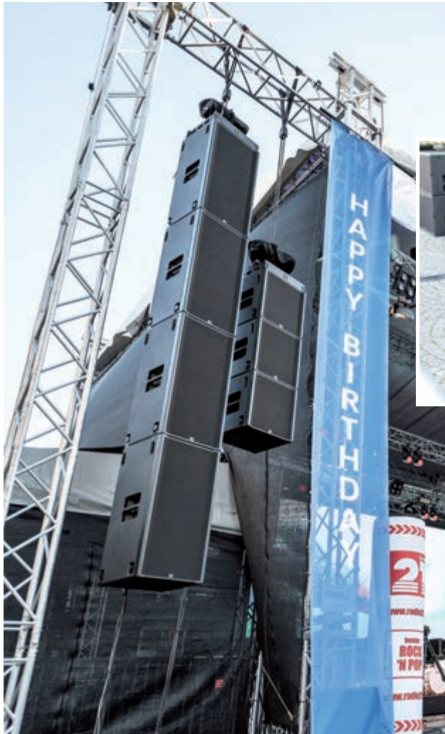
Bild 4: „Gestacktes“ Line-Array ohne Curving: Außen vier FV-200 Tief-Mitteltonöner, aus Platzgründen wurden innen drei FV-100 Hochtonöner gehängt – hinter dem Banner waren zusätzlich zwei XT4 Boxen als Nearfills positioniert (Foto: Fohhn Audio)
