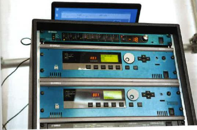
Die Yamaha DME64 mit einer AFC3-Firmware und MY4-AFC FIR DSP-Karte übernehmen die Signalbearbeitung und -verwaltung
