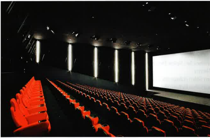
Lautsprecherausstattung in einem der Cinema8-Kinosäle mit Fohhn Linea LX-100 Linienstrahler und speziellen Deckenlautsprechern
