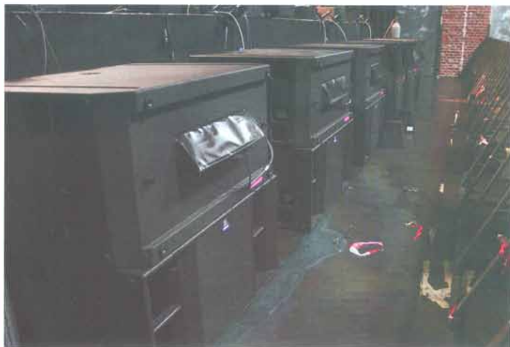
Im E-Werk kamen zwölf PS-9-Subwoofer zum Einsatz, eine Hälfte davon gedreht. Nach außen hin waren sie zusätzlich verzögert, um eine zu starke Richtwirkung zu verhindern.
