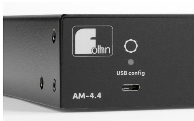
USB-C-Buchse (unten links) an der Gehäusevorderseite
