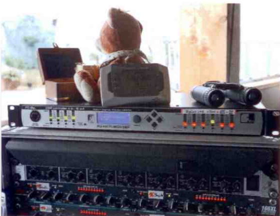
Für eine anspruchsvolle Signalaufbereitung ist in Grevesmühlen der erst seit kurzem erhältliche digitale Lautsprechermanagement-/Systemcontroller FC-8 aus dem Hause Fohhn zuständig.
