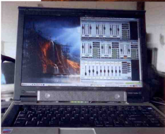
Bernd Hartmann verfügt an seinem Arbeitsplatz über einen Laptop, an dem sich mithilfe der „Fohhn Audio Soft 2.4.1“-Software sowohl die DSP-Amps als auch der FC-8 komfortabel überwachen und einstellen lassen.
