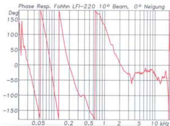
Abb. 2: Phasengang der LFI-220. Die relativ starken Phasendrehungen für ein Breitbandsystem entstehen u. a. durch den Drei-band-Limiter, benötigt zur Aufteilung der Frequenzbereiche in eine „Frequenzweiche“.
