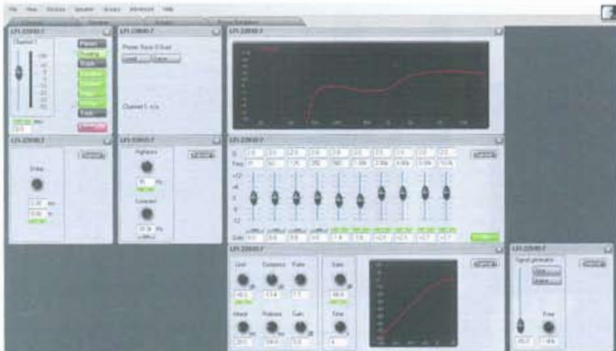
Abb. 13: PC-Software zur Linea Focus. Die Oberfläche umfasst eine Preset-Auswahl, einen 10-fach voll parametrischen EQ, einen Limiter-Compressor, ein Delay sowie Hoch- und Tiefpassfilter und einen Signaltongenerator.
