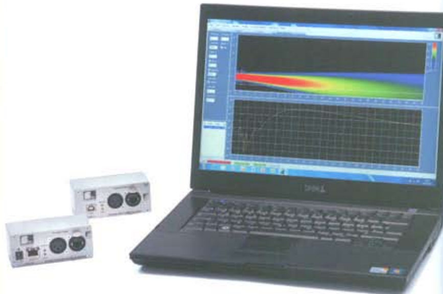
Software zu Linea Focus mit Einstellungen für das Beamforming. Links neben dem Notebook USB-RS485- und Ethernet-RS485-Interfaces.
