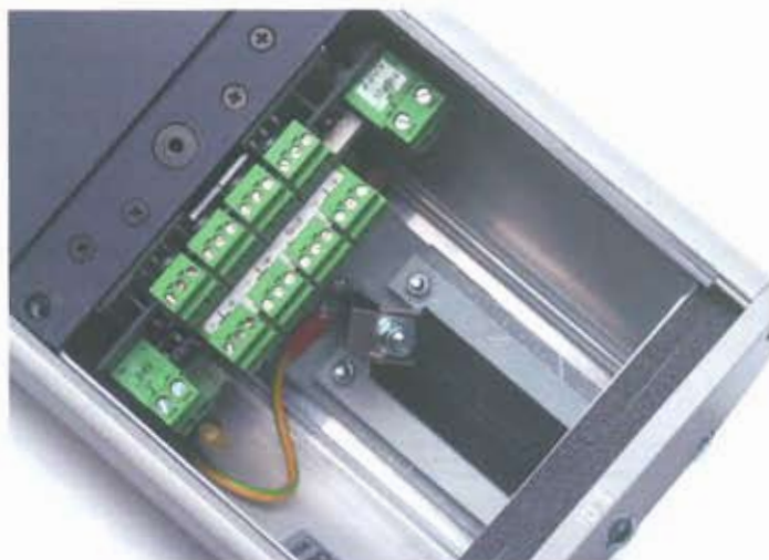
Anschlussfeld der Installationsmodelle mit 24 V Anschluss, zwei Eingängen, Fehlerkontakt, R5485 Netzwerkanschluss und 230 V Stromanschluss (v.l.n.r.)
