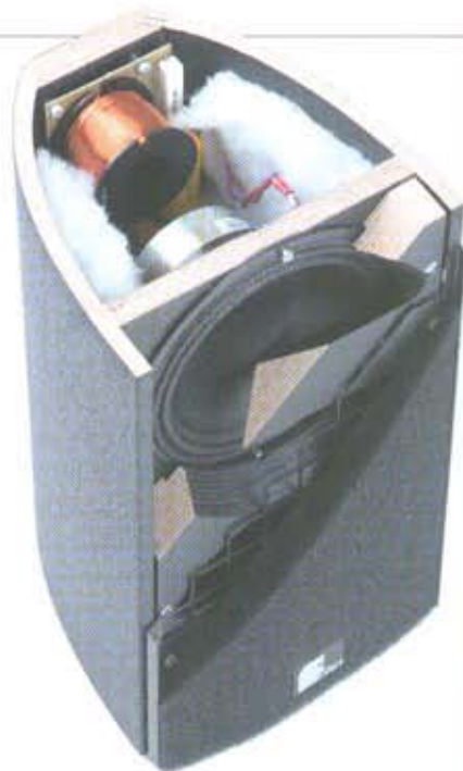
Schnitt durch eine LX-601 mit Tieftöner
