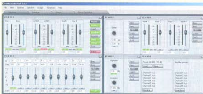
Abb. 17: PC-Software zum Fohhn-Controller mit einer intuitiven Oberfläche für alle wichtigen Funktionen. Lautsprecher- und Endstufen-Presets können aus einer Bibliothek geladen werden.
