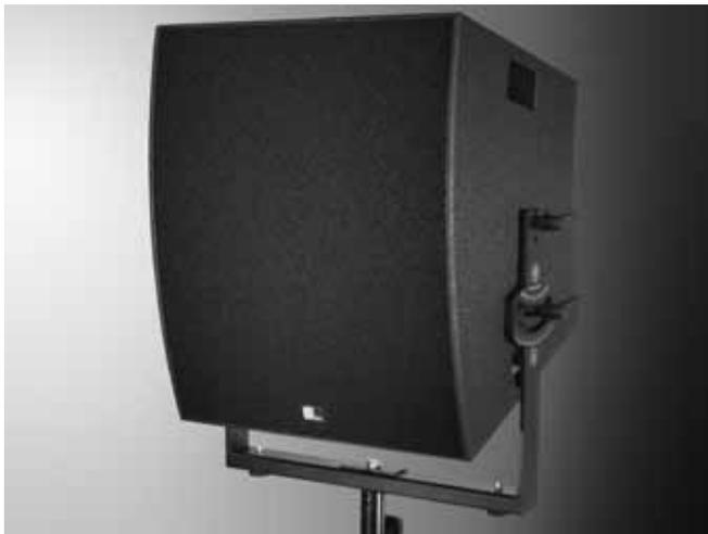
Das Fohhn® PT-6 ist ein Hochleistungs-Lautsprechersystem in Line-Array Technik, 6x 6,5" Neodym und 3x 1,4" Neodym Druckkammertreiber mit HF-Phase-EQ. Twin-koaxiale Lautsprecheranordnung. Nur 39 kg. 2-Wege-Aktiv/Bi-Amping-Modus.
