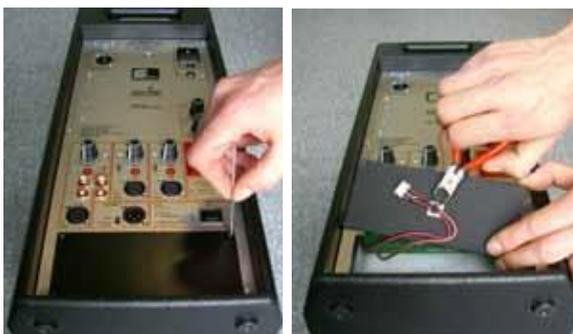
Schließen Sie den Kabelstrang an den Bluetooth-MP3/WAV-Player gemäß der Darstellung an.
